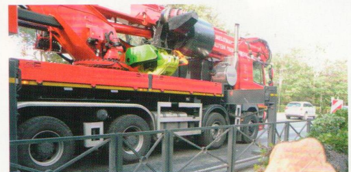
Om zich te verplaatsen of over de weg te rijden wordt het geheel weer samengevouwen. De kraan wordt nu naar voren gezwenkt en daarna over het dak neergelegd.
