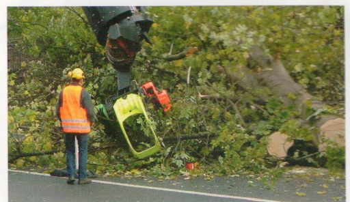
De opgebouwde velkop bestaat uit een takkenklem (geel) met onder en boven een hydraulisch aangedreven kettingzaag. (Groen en oranje op de foto)
